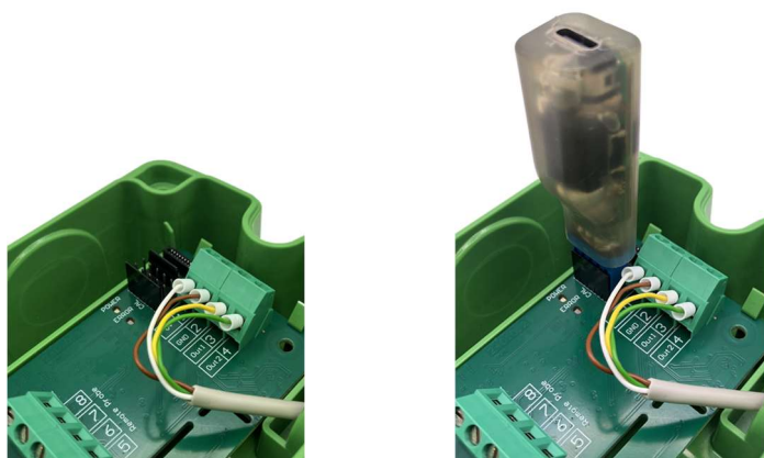
Рис. 2 Интерфейс конфигурации HTS401 с отключенным/подключенным конфигуратором USB-C
