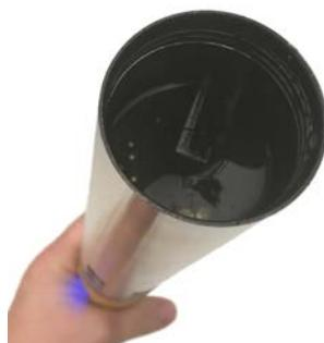
6. продвиньте раствор в калибровочную ячейку, чтобы убедиться, что она контактировала с поверхностью сенсоров и внутри калибровочной ячейки. Если необходимо, переустановите синюю крышку и аккуратно потрясите.
