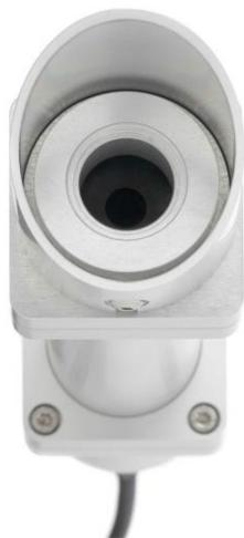
**Рисунок 2.** Пиргелиометр первого класса с быстрым откликом DR02, показывающий свой оконный блок из полированного кварца с нагревателем
