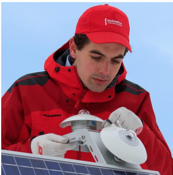
Рисунок 1. Пиранометр SR20 класса вторичный эталон
